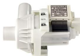
Die robuste Abschlämppumpe unterstützt das kombinierte Spül- und Kalkauffangsystem durch das Abschlämmen von Härtebildnern. So kann ausfallender Kalk ausgetragen werden und sammelt sich erst gar nicht an. Das verringert die Kalkmenge im Sieb und damit die Wartungshäufigkeit.
