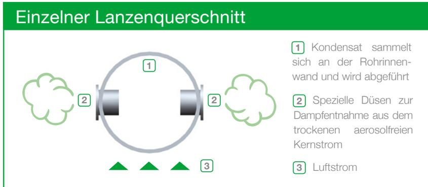
MultiLance Systeme sind einfach zu montieren, wartungsfrei und gewähren aufgrund der hochwertigen Edelstahlkomponenten eine lange Lebensdauer. Durch die eigens entwickelte Düsenform wird der Dampf aerosolfrei aus der Mitte der Lanze entnommen, so dass nachfolgende empfindliche Kanaleinbauten wirkungsvoll vor Kondensation geschützt werden.
