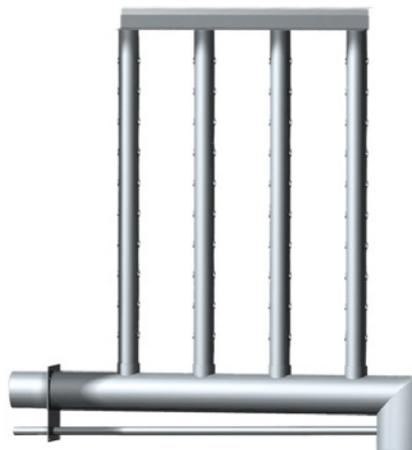
Die **HygroMatik MultiLance** Dampfverteilssysteme sind für den Einsatz bei extrem kurzen Befeuchtungsstrecken konzipiert und für **Elektroden- und Heizkörper-Dampfluftbefeuchter** sowie für **Druckdampfsysteme** geeignet. Sie sind auch bei hohen Strömungsgeschwindigkeiten bis 8 m/s im Lüftungskanal einsetzbar.
