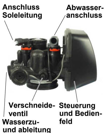
Zentralsteuerventil für WL-C, Anschlüsse
