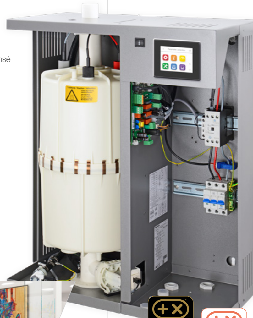
Électrodes de grande surface en acier inoxydable remplaçables pour différentes conductivités
