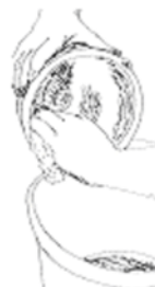
Nettoyez l'intérieur du cylindre. N'utilisez aucun produit acide ni autres produits chimiques
