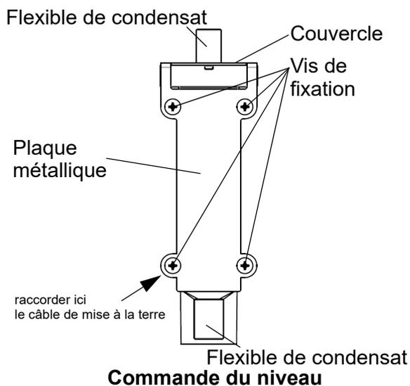
La commande du niveau n'est pas accessible lorsque le cylindre à vapeur est démonté.
