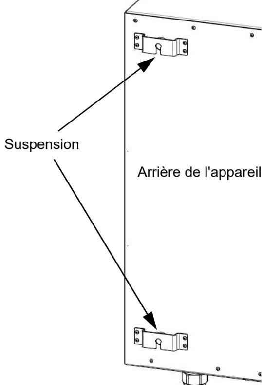
L'appareil doit être monté sur un mur stable.
