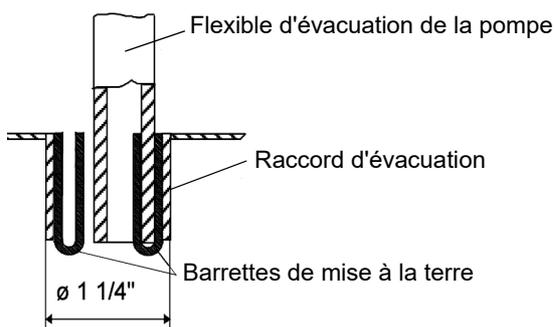
Les deux barrettes de mise à la terre disposées à l'intérieur du raccord d'évacuation du corps sont en contact direct avec l'eau pendant la vidange ou en cas d'erreur (trop-plein) et dissipent les éventuels courants résiduels sur le corps.
