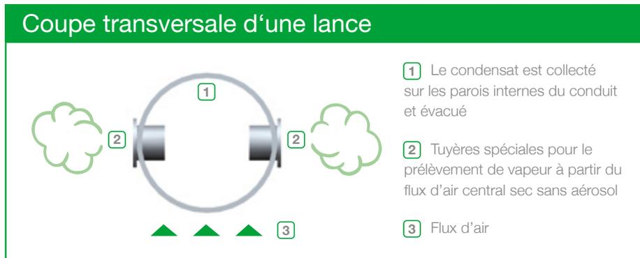
Les systèmes MultiLance sont simples à monter et à entretenir et la haute qualité des composants en acier inoxydable leur garantit une longue durée de vie. Grâce à la forme spéciale de la tuyère, la vapeur est extraite sans aérosol du centre de la lance, de sorte que les éléments sensibles du conduit en aval peuvent être efficacement protégés de la condensation.
