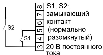
Клеммная колодка на ST08
