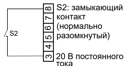
Клеммная колодка на ST08
