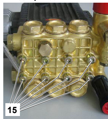
Винты крепления клапанного блока (8 шт.)
