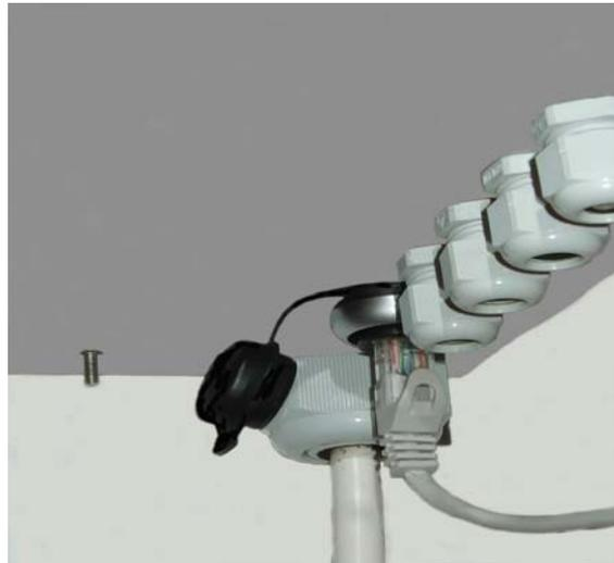
Anschluss des RJ45-Kabels an der Unterseite des Dampfgenerators
