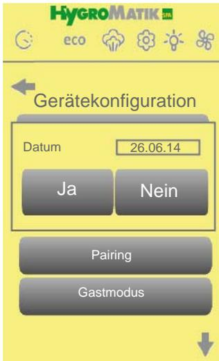
In diesem Menü können Sie die Uhrzeit und das Datum für die Steuerung des Dampfgenerators einstellen.
