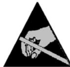
**Achtung:** Nichtbeachtung dieses Hinweises kann zur Beschädigung des Gerätes durch elektrostatische Entladung führen. Die elektrotechnischen Bauteile der Befeuchtersteuerung sind sehr empfindlich gegen elektrostatische Entladungen. Zum Schutz dieser Bauteile müssen für alle Installationsarbeiten Maßnahmen gegen Beschädigung durch elektrostatische Entladung (ESD-Schutz) getroffen werden.
