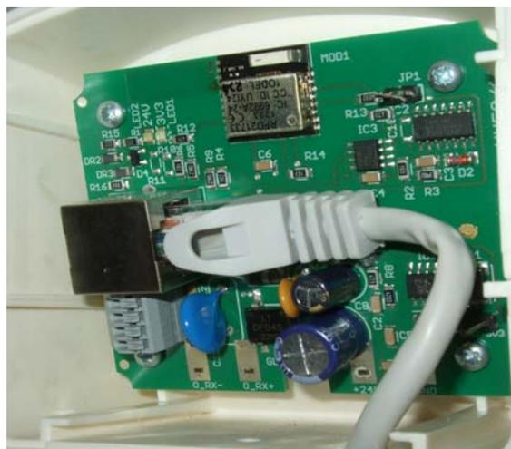
Anschluss des RJ-45-Kabels an der Ladeschalenelektronik
