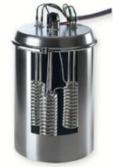
1 bis 5 hochwertige Heizkörper erhitzen das Wasser im **Edelstahlzylinder** nach dem Tauchsiederprinzip. Der mechanische Überhitzungsschutz der Heizkörper sorgt zusammen mit dem Niveauregler für doppelten Trockengeh-Schutz.
