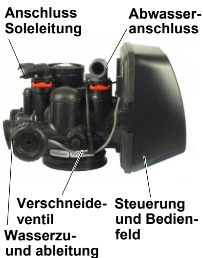
Zentralsteuerventil für WL-C, Anschlüsse
