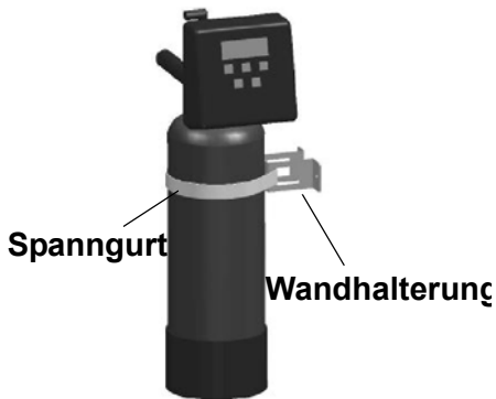
Sicherung der Enthärtungsanlage mit Wandhalterung und Spanngurt
