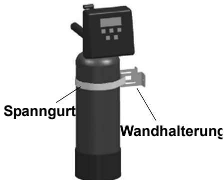
Sicherung der Enthärtungsanlage mit Wandhalterung und Spanngurt
