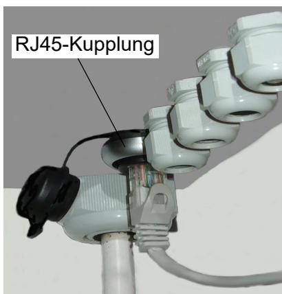
Zum Anschluss des Spa Touch Control an diese HygroMatik-Dampfgeneratoren wird ein Anschluss-Kit benötigt. Bestandteil dieses Kits ist u.a. eine RJ45-Kupplung in Form einer Gehäuse-durchführung (s. nebenstehende Abb.).
