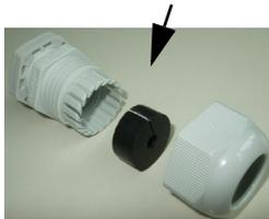
Lorsque l'on dévisse l'écrou-raccord du presse-étoupe, il est possible de retirer le joint d'étanchéité intérieur. Celui-ci peut être remplacé par un joint à fente (compris dans les accessoires fournis) qui peut être plié pour insérer le câble.
