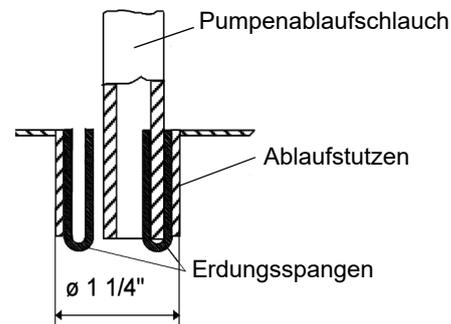
Die an der Innenseite des Gehäuseablaufstutzens angebrachten beiden Erdungsspannen haben während des Abschlämmens oder im Fehlerfall beim Überlaufen direkten Kontakt mit dem Wasser und leiten eventuell auftretende Restströme an das Gehäuse ab.
