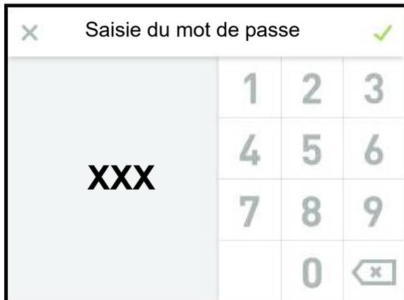
Afin d'accéder au niveau utilisateur, il suffit de sélectionner le symbole X (à gauche en haut). Saisir séquentiellement les chiffres « 0 », « 1 » et « 0 » et confirmer le code à l'aide de la case cochée verte (à droite en haut) permet d'accéder au niveau opérateur.
