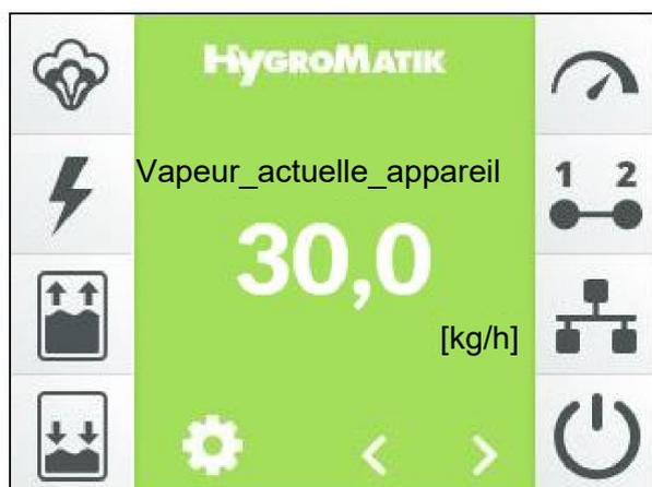
La vue principale s'affiche sur l'écran après l'activation de l'appareil, à moins qu'il ne s'agisse d'une première mise en service (voir section « Mise en service »). La vue principale affiche les données de service actuelles sous forme de données chiffrées ainsi que les informations de statut de l'appareil sous forme de symboles. La description des éléments d'affichage se trouve à la section 4 « L'écran ». Un symbole clignotant indique toujours un défaut.
